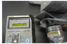
図4 ガイガーでの測定
