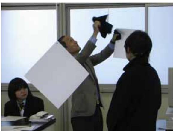
次に，天井から絶縁して下げたテフロン板を布で強く摩擦して負に帯電させ，正に帯電したラドンの娘核種を化学室内で1時間集塵した。このテフロン板を濾紙でふき取り，ガイガーカウンタの窓に貼り付けて2分おきに10分間計数した（本来は2時間計数）。集塵の間，閃ウラン鉱から出る放射線が金属（アルミニウム，銅，鉛）やプラスチック等の材質や，その厚さによってどのように減衰するか，はかる君とガイガーカウンターを用いて計測した（実験の様子動画を付属 CD-R に収録した）。
