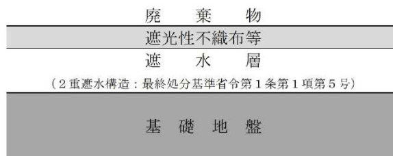
図-4.3.1 表面遮水工の構成
